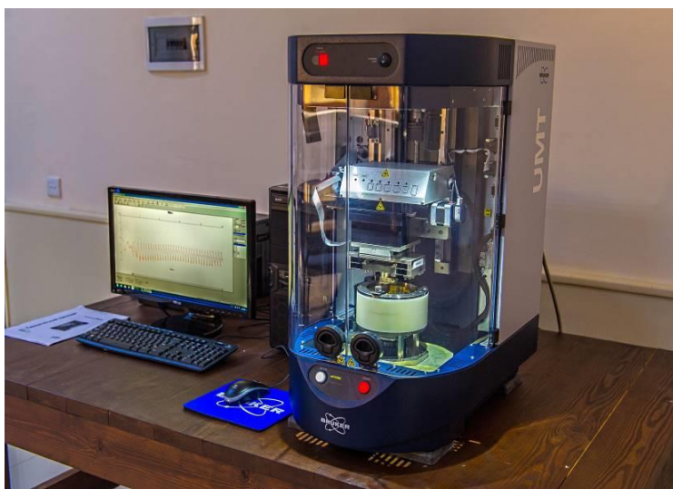
Рис. 2. Общий вид установки для трибологических испытаний UMT-2 TriboLab
