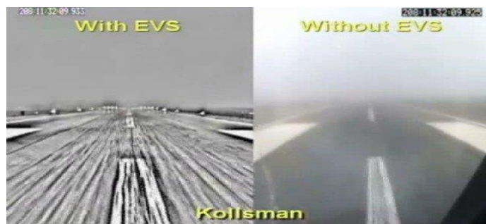
Рис. 1. Вид на ВПП: слева с использованием системы EVS, справа без использования системы EVS
