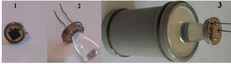
Şək.1 MPSF diod və NaI ssintilyator kombinasiyası. 1-MPSF diod, 2-MPSF diod və Vinston konusu və 3-MPSF diod+Vinston konusu və NaI ssintilyator.
