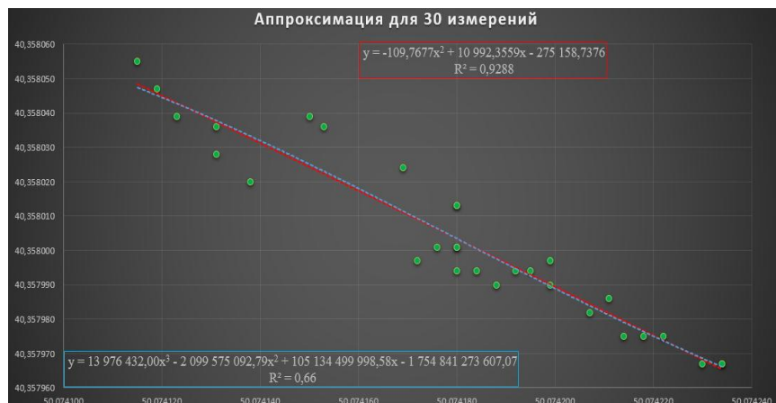
Рис. 5. Использование полиномов 2 и 3 степени для аппроксимации результатов измерений
