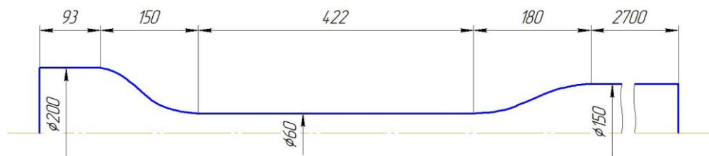
Рис. 1. Геометрическая модель канала гасителя колебаний
