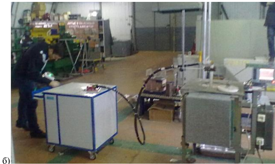
Рис. 1. Комплекс для магнитно-импульсной обработки расплавов.
