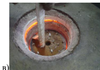
Рис. 1. Комплекс для магнитно-импульсной обработки расплавов.
