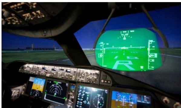
Рис. 1. Устройство отображения информации, предназначенное для отображения символической информации на лобовом стекле, на фоне кабиной обстановки
