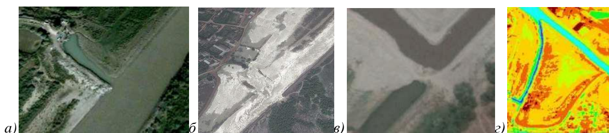
Рис. 5. а - вид канала в 2005 г, б - прорыв канала в 2010 г, в - постройка дамбы в 2016 г, г - NDVI, показывает перекрытие канала и высыхание его русла в 2016 г.
