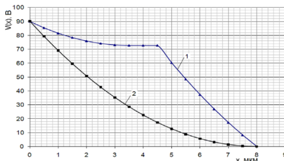
Рис. 2. Распределение потенциала в образце МЛФД: 1 – распределение потенциала в сечении «а», 2 – распределение потенциала в сечении «b»
