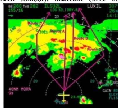
Рис.2 Индикация метеообстановки на навигационном дисплее самолета
