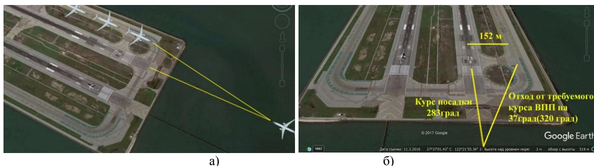
Рис. 1. Заход на посадку на ВПП 28R. а) ВС, намеревающееся выполнить визуальный заход, б) ВС, отклонившееся от требуемого курса ВПП.
