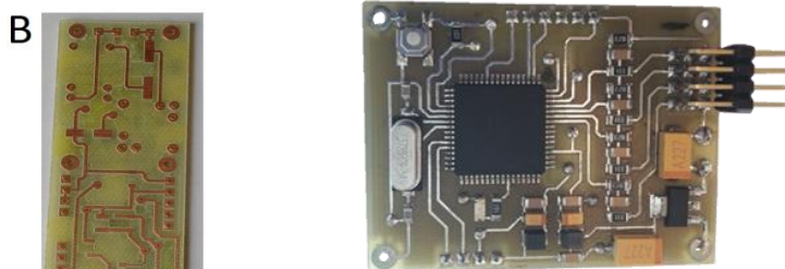
Şəkil 4. A - LPKF Protomat S-63 dəzgahı, B - hazırlanan elektron plata nümunəsi
