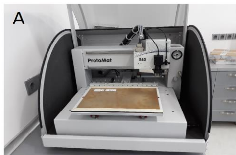
Şəkil 4. A - LPKF Protomat S-63 dəzgahı, B - hazırlanan elektron plata nümunəsi
