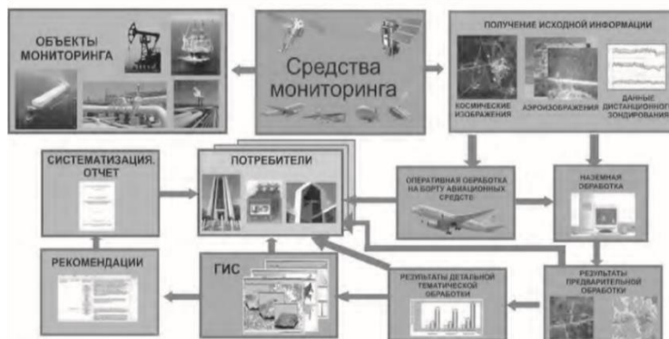
Рис. 1. Структурная схема проведения аэрокосмического мониторинга объектов нефтегазового комплекса
