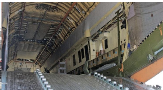
Şəkil 2. “ULD” və səthi süz yüklərin yükləmə-boşaldılması üçün xüsusi qurğu
