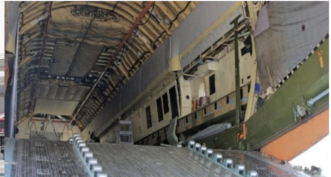
Şəkil 2. “ULD” və səthi süz yüklərin yükləmə-boşaldılması üçün xüsusi qurğu
