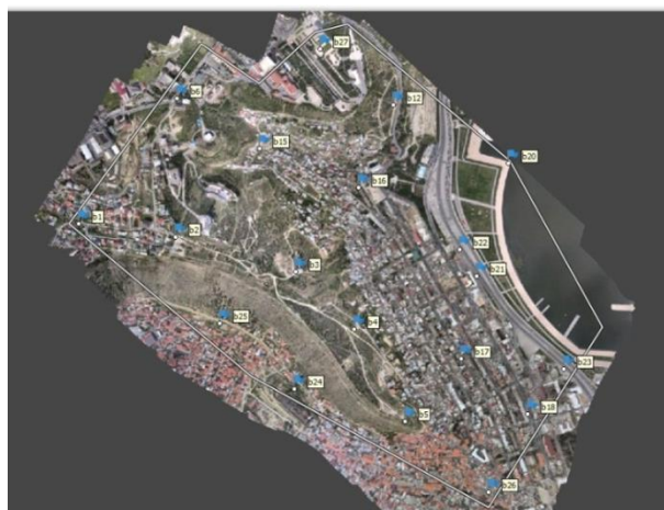
Рис. 2. Ортофотоплан сделанный с камерой GoPro Hero 6
