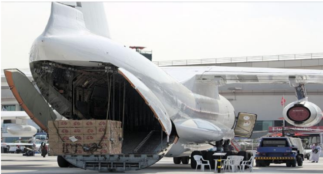
Şəkil 1. Telfer vasitəsilə “ULD”nin İL-76TD hava gəmisinə yüklənməsi
