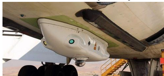
Рис.1. Лазерная система защиты от атак ПЗРК
