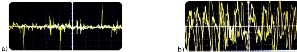
Şəkil 6. 7BB-27-4L0 markalı pyezovericidən alınmış səs osilloqramları: a) Mühərrikin normal işi zamanı, b) Mühərrikdə sürtünmənin artması zamanı
