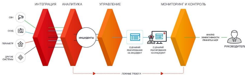
Şəkil 1. ESM proqramına daxil olan təhlükə siqnallarının idarəetmə sxemi
