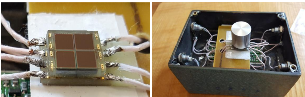
Şəkil 1. 4 ədəd MAPD-3NK-dan ibarət matris və LiI (Eu) ssintilyatoru
