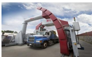
Şəkil 1. Yüklərə və nəqliyyat vasitələrinə baxış üçün skaner
