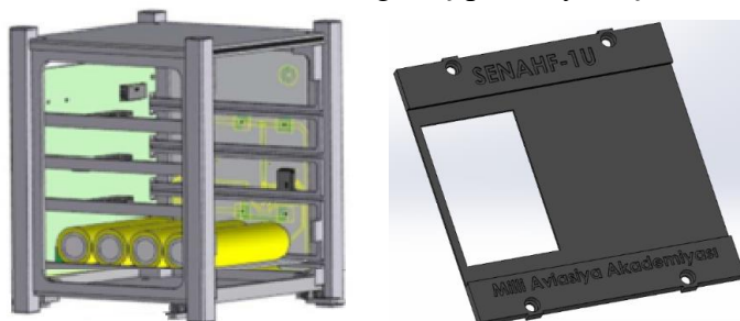
Şəkil 1. SENAHF-1U nanopeykində akkumulyatorların və günəş panellərinin yerləşdirilməsi
