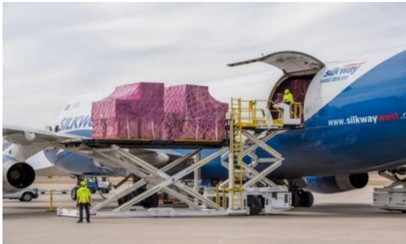
Şəkil 2. B747-400F yük hava gəmisinin yüklənməsi prosesi
