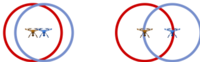
Şəx. 1. Dronların qeyri-optimal rabitə diapazonunda(sol) və optimal rabitə diapazonunda (sağ) olmaları
