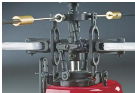
Рис. 1. Традиционная система включает в себя два серводвигателя внизу с рычажными механизмами, направленными вверх к автомату перекоса, и дополнительными рычажными механизмами, направленными вверх, для приведения в действие оси шага лопасти.
