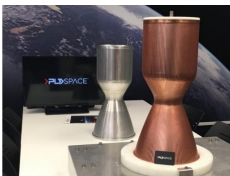
Рис. 2. Внутренняя стенка камеры ЖРД TERREL-A ракеты MIURA 1(Бразилия)
