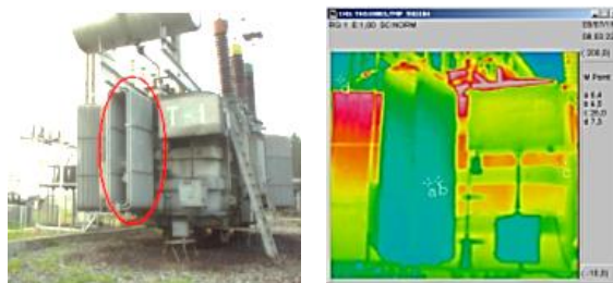
Şəkil 4. Radiatorlarda yağın sirkulyasiyasının olmamasını göstərən termogram və təsvir (ovalın daxilində)
